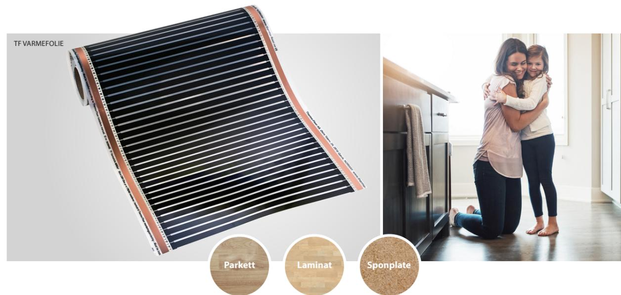
TF varmemefolie er et smart valg når du vil sikre deg komfortvarme i alle tørre rom. Varmefolien legges på varmereflekterende isolasjon og kan overdekkes av flytende parkett, laminat eller spon.
