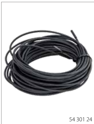
GULVFØLER Ø 4,5MM NTC 10 kΩ @ 25°C Standard føler til Multireg. Kabellengde 15 meter.
