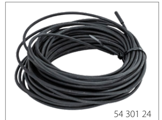
GULVFØLER Ø3MM NTC 10k \Omega @ 25°C Standard føler til Multireg og Heatit termostater. Kabellengde 15 meter.
