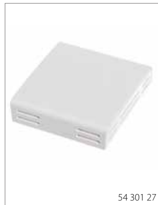
EKSTERN KAPSLET FØLER IP 20/54 NTC 10 kΩ @ 25°C For innendørs og utendørs bruk. Passer over veggboкс. Arbeidstemperatur -10°C - 60°C Maks lengde tilførselskabel 50 meter Tverrsnitt tilførselskabel 2 x 1mm 2 Størrelse (LxBxH) 82 x 88 x 25mm
